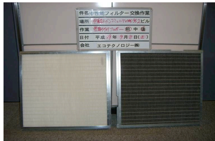
中性能フィルタ 洗浄型フィルタ(左)と使用後フィルタ(右)
